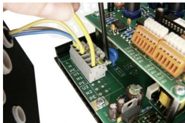
obr. 8 - připojení vodičů do svorek
