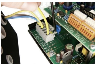
obr. 8 - podłączenie przewodów do zacisków
