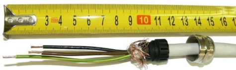
obr. 8 - podłączenie przewodów do zacisków
